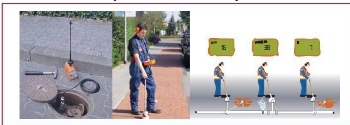
Figura: Geófono localizador de fugas
